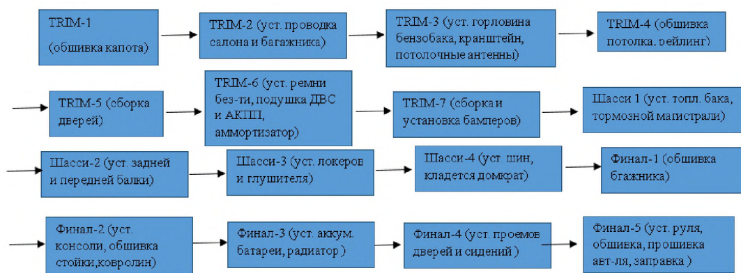
Рисунок 11 - Схема прохождения сборки автомобиля на линии CKD
